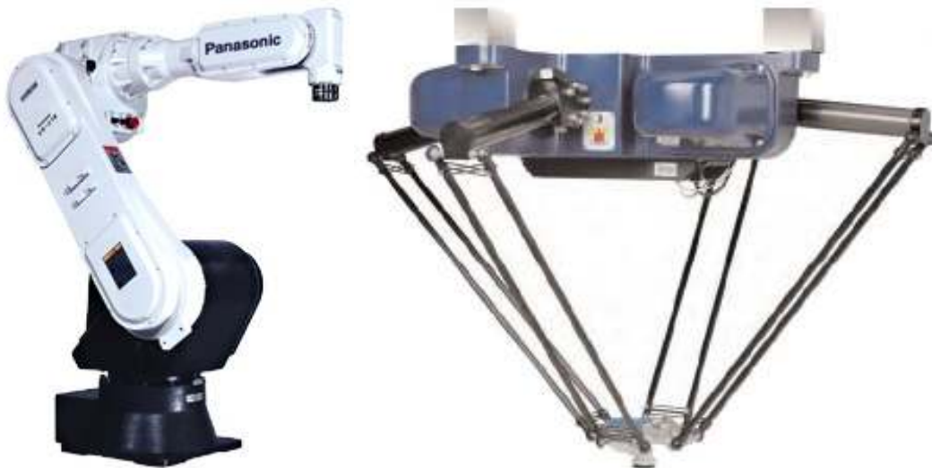
Figura 3.20 – Um braço revoluto de cadeia aberta comercializado pela Panasonic (à esquerda) e o robô paralelo Quattro produzido pela Adept (à direita).
